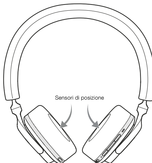
Figura 4 Ubicazione dei sensori di posizione
