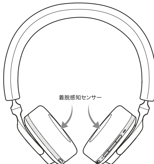
図4 着脱センサーの位置
