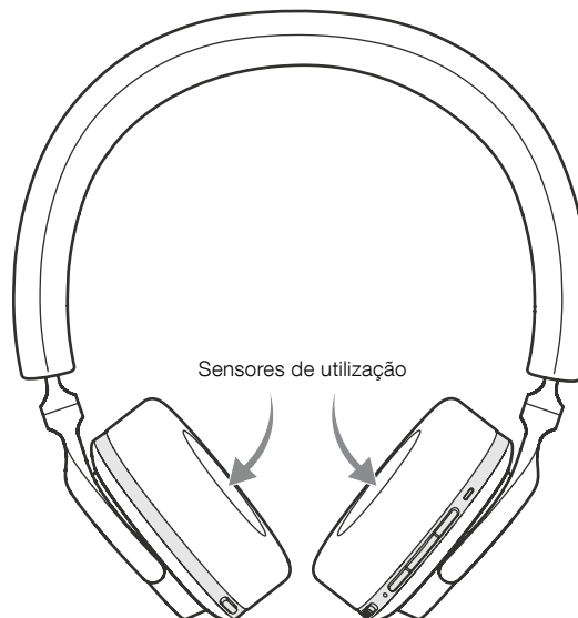
Imagem 4 Localização dos sensores de utilização
