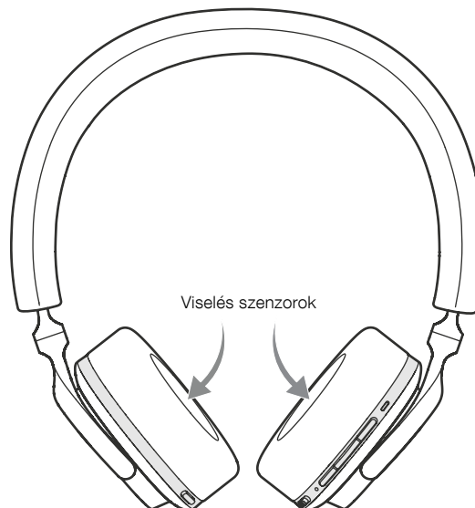
4. Ábra A viselés szenzorok elhelyezkedése
