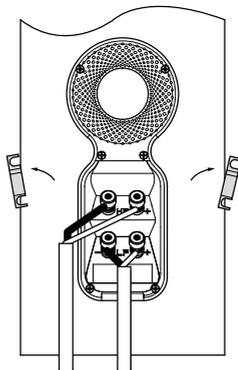
確保揚聲器上的正極端(標有+和紅色)與放大器的正極輸出端相連接，而揚聲器上的負極端(標有-和黑色)與放大器的負極輸出端相連接。不正確的連接會導致結像效果差和低音失真。
