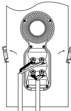
Upewnij się, że gniazda połączeniowe oznaczone +, z czerwonym obramowaniem zostały połączone z gniazdami o dodatniej polaryzacji na wzmacniaczu a gniazda oznaczone -, z czarnym obramowaniem z gniazdami o ujemnej polaryzacji na wzmacniaczu. Nieprawidłowe podłączenie będzie skutkowało pogorszeniem jakości dźwięku i utratą niskich tonów.
