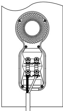
Wszystkie podłączenia powinny być dokonywane przy wyłączonych urządzeniach audio.
