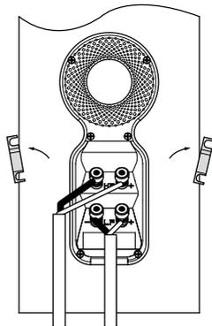
确保扬声器上的正极端（标有+ 和红色）与放大器的正极输出端相连接，而扬声器上的负极端（标有- 和黑色）与放大器的负极输出端相连接。不正确的连接会导致结像效果差和低音失真。
