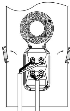
Zorg ervoor dat de positieve aansluitingen van de luidspreker (rood gekleurd en van een + voorzien) met de positieve uitgang van de versterker worden verbonden en de negatieve aansluitingen van de luidspreker (zwart gekleurd en van een - voorzien) met de negatieve uitgang van de versterker worden verbonden. Foutieve aansluiting geeft een minder goed ruimtebeeld en verlies aan bas.
