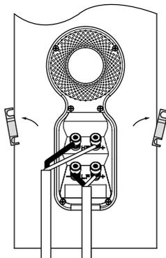
スピーカーのプラス端子(“+”のマークがあり、端子の色は赤)をアンプのプラス出力端子に、スピーカーのマイナス端子(“-”のマークがあり、端子の色は黒)をアンプのマイナス出力端子を確実に接続します。間違った接続を行った場合、サウンドイメージが広がらないとか、低音が出ないといった現象が起きます。
