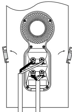
Certifique-se de que os terminais positivos da coluna (marcados com o sinal + e de cor vermelha) estão ligados ao terminal de saída positiva do amplificador e que os terminais negativos da coluna (marcados com o sinal - e de cor preta) estão ligados ao terminal de saída negativa do amplificador. Uma ligação incorrecta pode resultar numa imagem fraca e na perda de sons graves.
