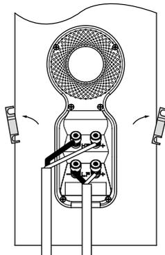
Bizonyosodjon meg arról, hogy a hangsugárzó pozitív terminálja (+ jellel jelölt és piros színű) az erősítő pozitív kimenetéhez csatlakozik, valamint a hangsugárzó negatív terminálja (- jellel jelölt és fekete színű) az erősítő negatív pontjához csatlakozik. Fordított csatlakozás esetén a hangkép zavaros és a mélyhang hiányos lesz. A zörgések elkerülésének érdekében mindig szorosan húzza meg a csatlakozókat.
