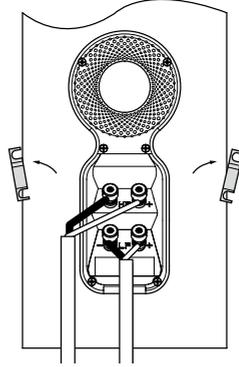
Hoparlördeki pozitif terminallerin (+ işaretli kırmızı renkli) amplifikatördeki pozitif çıkış terminallerine ve negatif terminallerin (- işaretli siyah renkli) amplifikatördeki negatif çıkış terminallerine bağlı olduğundan emin olun. Yanlış bağlantı durumu, kötü imgelemeye ve bas seslerde kayıp yaşanmasına yol açabilir.
