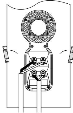
Stellen Sie sicher, dass die positiven (roten und mit + gekennzeichneten) Anschlussklemmen am Lautsprecher mit dem positiven Ausgang am Verstärker und die negativen (schwarzen und mit - gekennzeichneten) Anschlussklemmen mit dem negativen Ausgang am Verstärker verbunden werden. Ein nicht korrektes Anschließen der Kabel kann zu einer Verschlechterung des Klangbildes und zu Bassverlusten führen.
