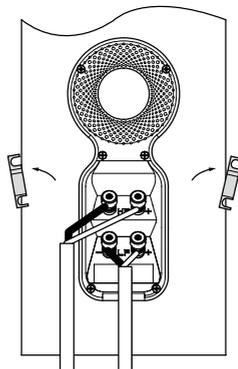
Assicurarsi che i terminali positivi del diffusore (indicati con + e di colore rosso) siano collegati al terminale di uscita positivo dell'amplificatore, ed i terminali negativi (indicati con - e di colore nero) a quello negativo. Un collegamento errato non crea danni, ma darà origine ad una scadente immagine sonora e ad un'insufficiente gamma bassa.
